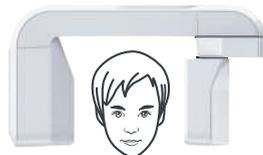
Les patients de petite morphologie bénéficient d'un rapprochement du capteur lors de l'acquisition afin de réduire les doses émises.
