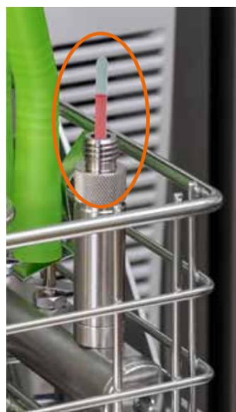
Insérez l'indicateur dans le ThermoTest et revissez la partie supérieure
