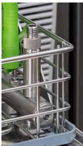
Dévissez la partie supérieure et insérez l'indicateur dans le ThermoTest
