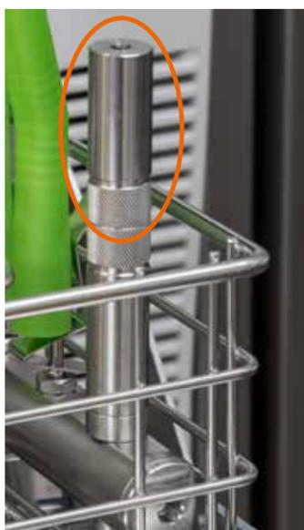
ThermoTest vissé sur la rampe d'injection pour corps creux en lieu et place d'un injecteur
