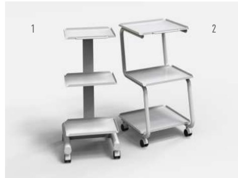
1. Tre ripiani per attrezzature elettriche. Dim: W38 H85 D43cm, ripiani W38 D32/29cm, distanza tra i ripiani 31cm. Portata 15kg (C502/C502A) 1. Cart (L38 H85 P43cm) pour appareils avec 3 étagères (L38 P32/29cm). Espace entre étagères 31cm; charge utile Kg.15
